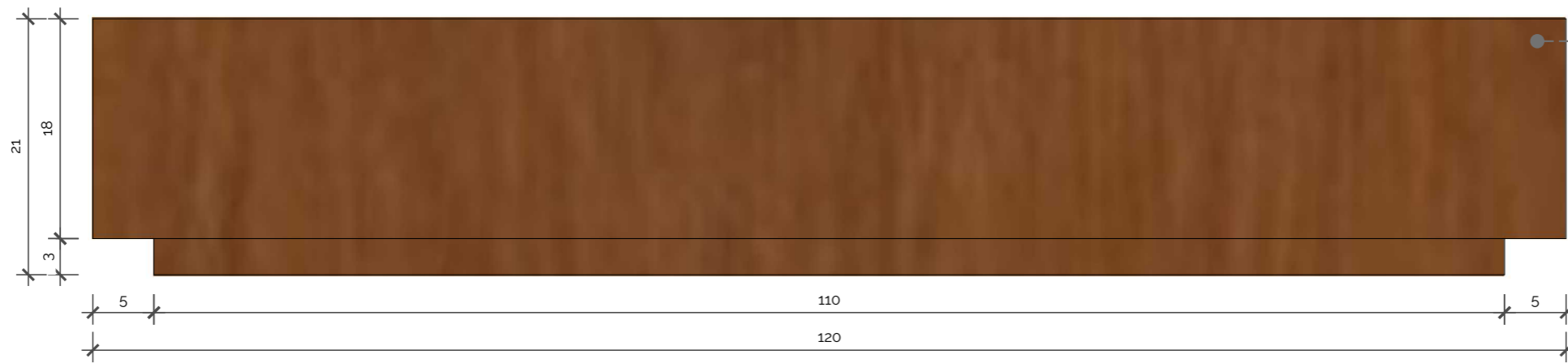
Det. M36 - Mesa de Centro (Vista Frontal) Esc.: 1/5 01 Unidade
