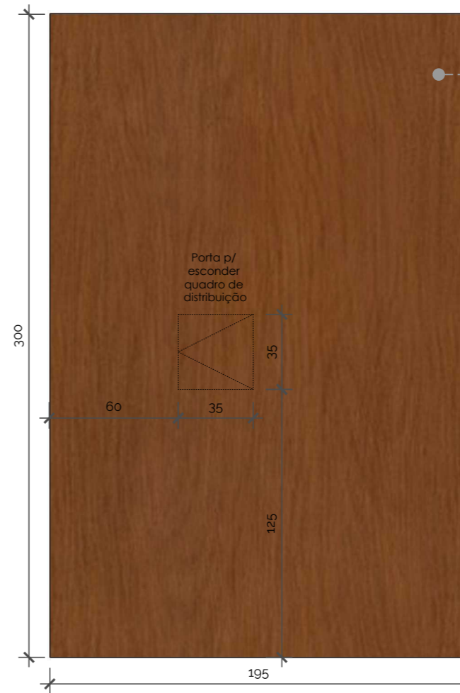
Det. M35 - Painel em "L" (Vista C) Esc.: 1/25 01 Unidade
